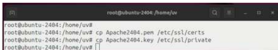
Pilt 15 - sertifikaadi ja selle privaatvõtme asetamine konteinerisse
